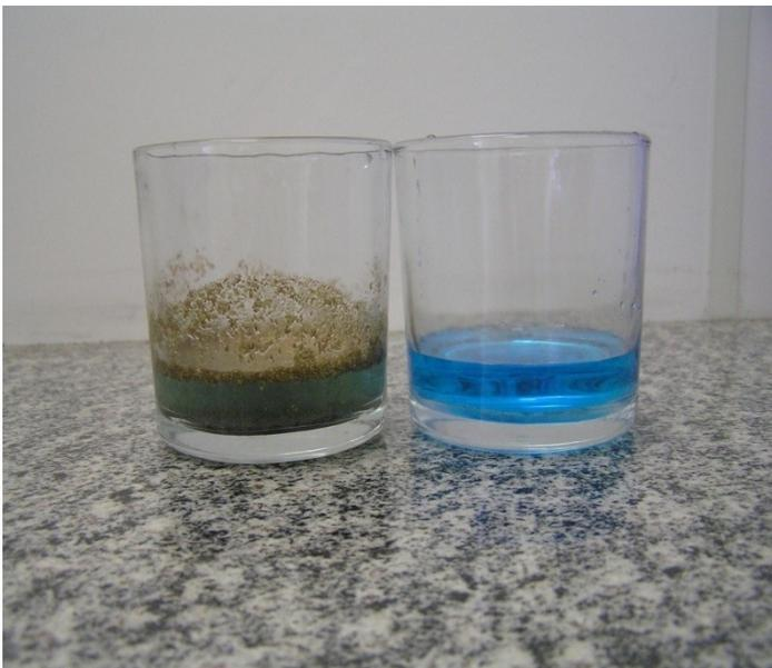
Figura 4- Eficiência no processo de remoção da cor
