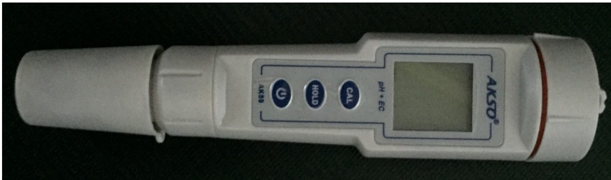
Figura 1. Medidor de pH e condutividade de bolso, modelo AK59.
