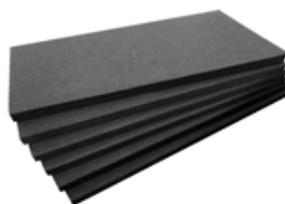
Figura 4: Placas (painéis) de Lã de PET
