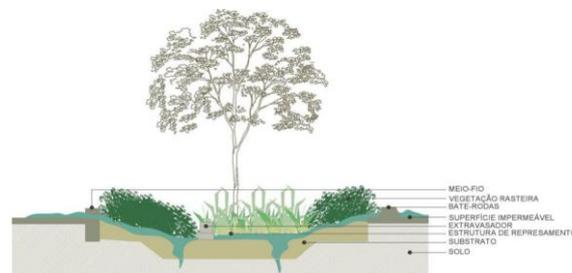
**Figura 3:** Esquema de uma biovaleta. Fonte: Adaptado pelos autores de COMIER; PELLEGRINO (2008)
