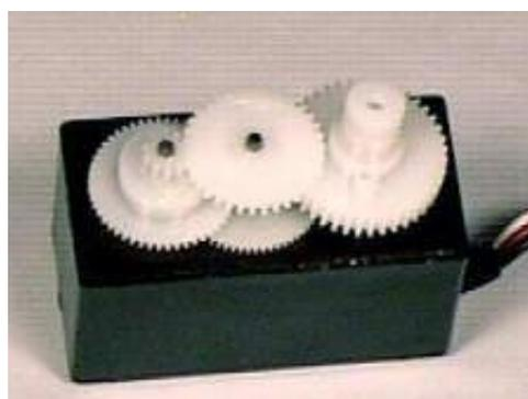
Figura 7 - Engrenagens internas do servomotor
